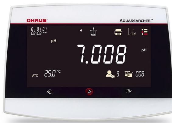
Возможность сохранения в памяти до 1000 результатов измерений и данных калибровки повышает эффективность документирования информации. Функции управления паролями упрощают регистрацию результатов в соответствии с требованиями GLP. Стандартные интерфейсы RS232 и USB позволяют подключать внешние устройства, например принтер или компьютер, для передачи и хранения данных.
