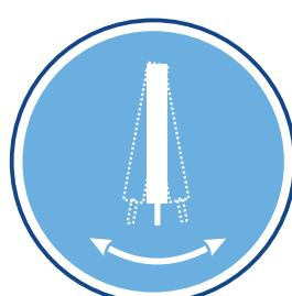
Вибрация индикаторного электрода при проведении измерений повышает точность и чувствительность анализа.
