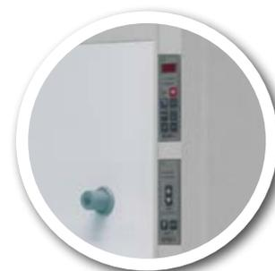
Встроенный монитор воздушного потока
