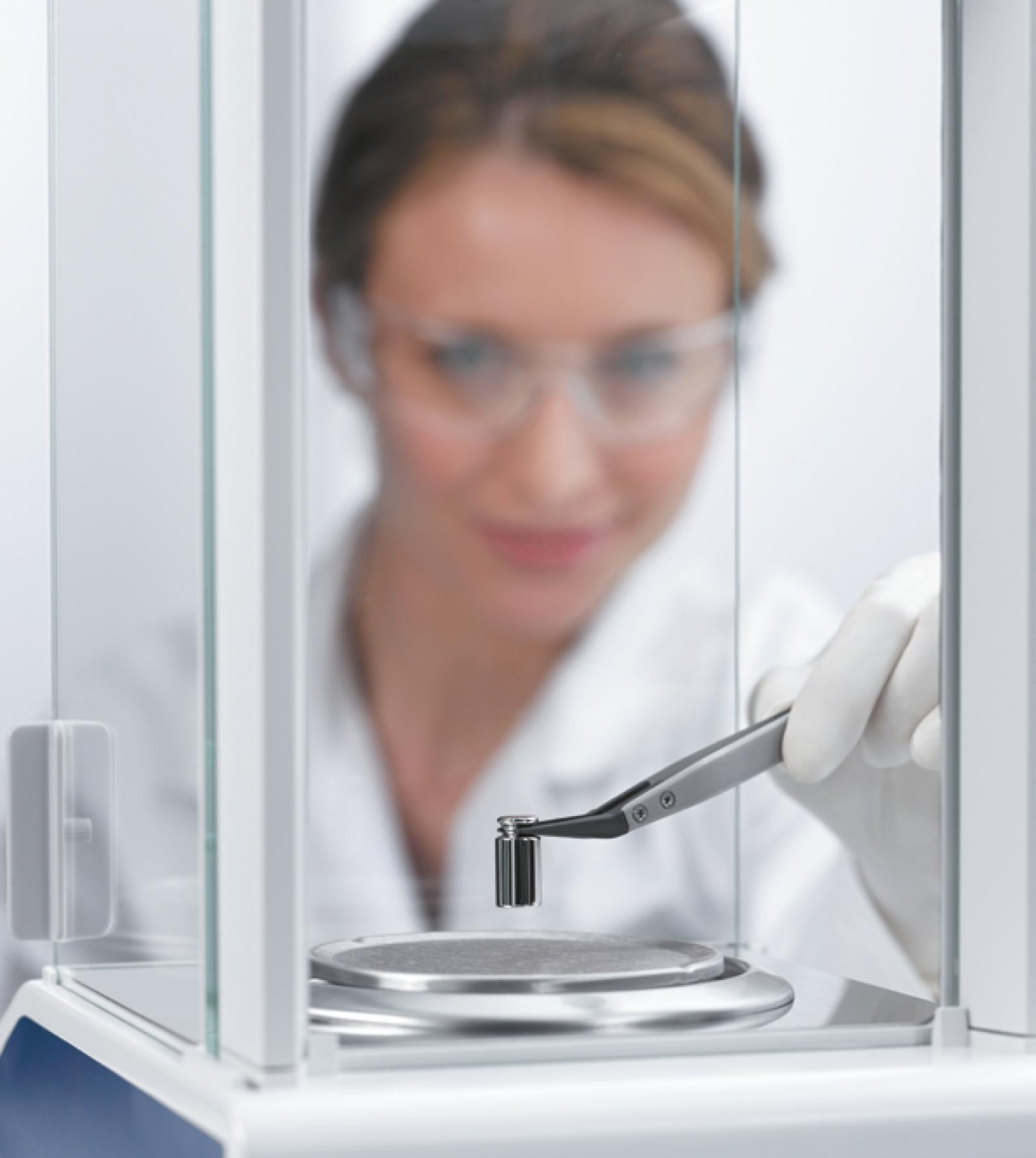
Встроенная функция журнала ISO обеспечивает полную прослеживаемость метрологически значимых настроек весов. Все изменения, выполненные во время тестирования или с помощью встроенной калибровки FACT, регистрируются автоматически.
