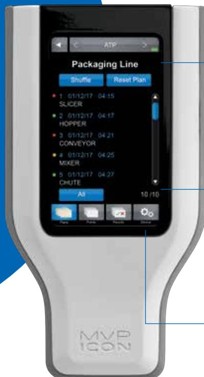
**Мультипараметровая платформа** позволяет наблюдать, отслеживать и корректировать большое число показателей НАССР, включая уровень АТФ, концентрацию, проводимость, значение pH и температуру.
