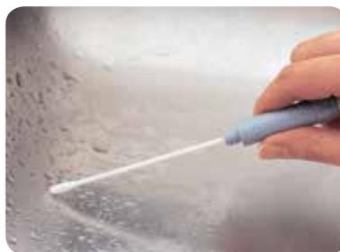
Запатентованные реагенты препятствуют возникновению химических помех и позволяют проводить измерение уровня АТФ как до обработки, так и после неё.
