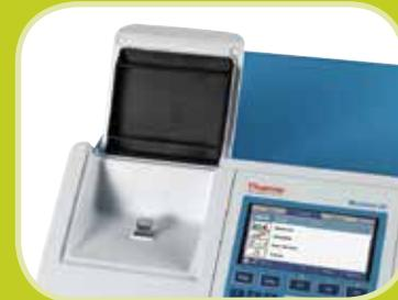
*Multiskan GO accepts versatile cuvettes*
