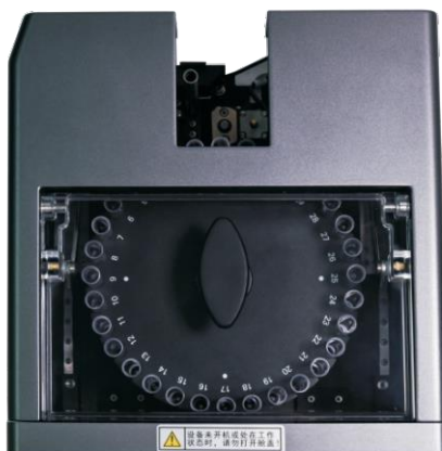
Рисунок 1-7 Модуль автоматического пробоотборника на поворотном столе
