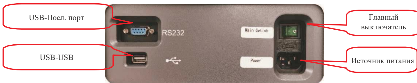
Рисунок 1-5 Основной блок и рабочая станция / подключение питания
