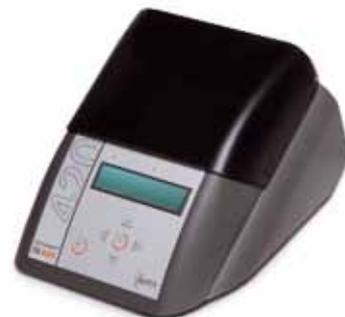
две отдельные термостатируемые зоны нагрева, имеется встроенная защитная крышка для определения ХПК и ТОС, а также для определения общего содержания кадмия, хрома, меди, цианидов, железа, свинца, никеля, азота, фосфора, серебра и цинка.
