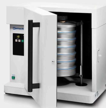
**Аналитическая просеивающая машина AS 200 tap** используются для исследований и разработки, контроля качества сырья и готовой продукции, а также в контроле производственной деятельности. Горизонтальное циркуляционное движение с вертикальными ударами позволяет проводить **ситовой анализ определенных продуктов**, таких как активированный уголь, абразивные материалы, металлические порошки, специи и алмазы **в соответствии с требованиями соответствующих стандартов**.
