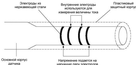
В датчиках STCON3 используется 4-х электродный потенциометрический метод измерения электропроводности, при котором на корпусе датчика располагаются четыре электрода из нержавеющей стали. Такая конструкция полностью исключает поляризацию, которая имеет место при использовании 2-х электродного амперометрического метода. Кроме того, неполяризующийся датчик позволяет измерять электропроводность в более широком диапазоне, поскольку на его характеристики не влияет электролиз.
