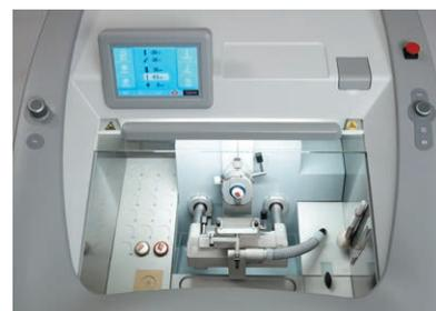
\* Система вакуум способствует лучшему расправлению среза и автоматически удаляет из рабочей камеры отходы, образующиеся во время резки.
