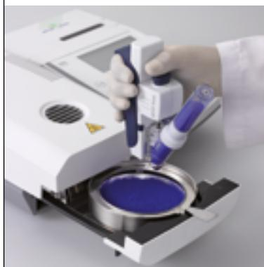
С помощью дозатора Quantos HPD можно быстро и равномерно распределить образец без образования пыли
