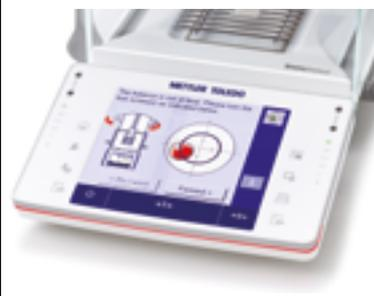
При отклонении от горизонтального положения весы выдают звуковой сигнал и предупреждение на дисплее. Функция **LevelGuide** помогает выровнять весы за несколько секунд, не глядя на пузырек – его положение отображается на дисплее.
