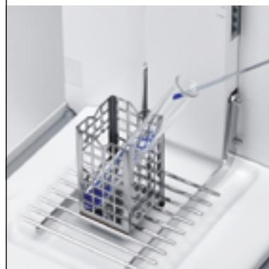
Небольшой заряд образцов и тары можно экранировать с помощью специальных металлических контейнеров, входящих в набор **ErgoClip**.
