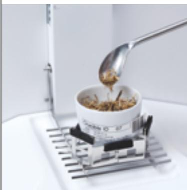
Весы XPE и ПО LabX позволяют автоматизировать анализ влажности или определение сухого остатка на аналитических весах XPE. Тигли маркируются с помощью термостойкой этикетки с штрих-кодом, все расчеты проводятся автоматически. По окончании анализа формируется отчет в электронном виде.
