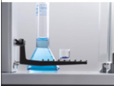
ХРЕ – это единственные микровесы с подвесной решетчатой чашкой. Такая конструкция обеспечивает быструю стабилизацию показаний даже при дискретности весов 1 мкг.
