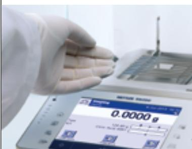
**SmartSens** – это два сенсора, встроенные в терминал по краям. Достаточно поднести к датчику руку или предмет, и весы выполняют запрограммированное действие, например, откроют или закроют дверку кожуха.
