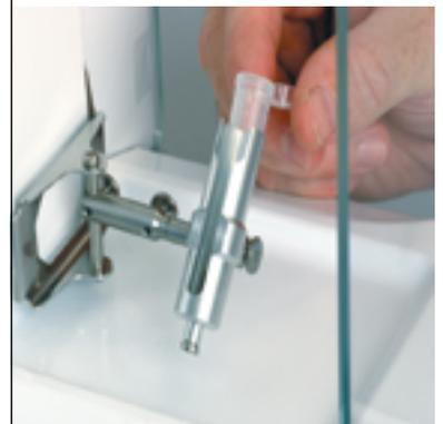
Держатель **ErgoClip Tube** предназначен для удобного и безопасного взятия навесок в пробирки и эппендорфы.
