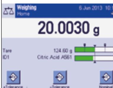
Цветная шкала **SmartTrac** поможет взять навеску в пределах установленного пользователем допуска. За пределами допусков шкала окрашивается в красный цвет, в пределах допусков – в зеленый.
