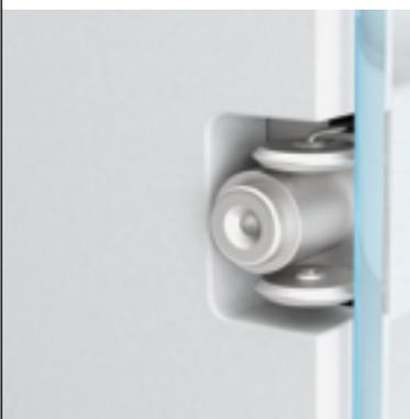
Новый компактный антистатический комплект позволяет устранить электростатический заряд, не создавая турбулентных потоков в весовой камере.
