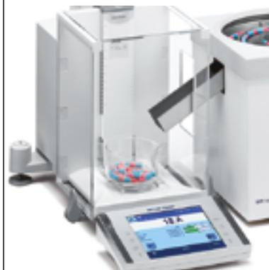
С помощью весов XPE, LV11 и программного обеспечения LabX можно определить среднюю массу таблетки за несколько минут. Программа автоматически произведет расчет (среднее, минимальное, максимальное, отклонение от среднего) и сформирует отчет для печати на листе A4 и в электронном виде.
