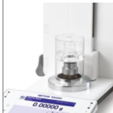
Проверку точности пипеток и дозаторов проводят на лабораторных весах гравиметрическим способом. Для получения надежных результатов весы необходимо оснастить специальной антииспарительной ловушкой.
