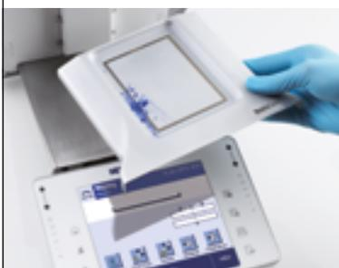
Съемный поддон располагается под решетчатой чашкой и служит для сбора просыпанных реактивов и пролитых жидкостей. Его можно снять одним движением и помыть в посудомоечной машине.
