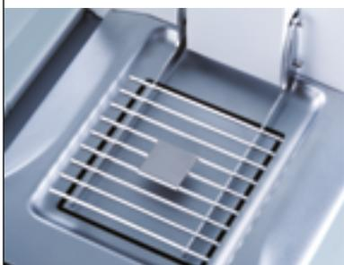
Решетчатая чашка **SmartGrid** устойчива к воздействию воздушных потоков благодаря небольшой площади поверхности. Время стабилизации показаний у весов с решетчатой чашей значительно сокращается.
