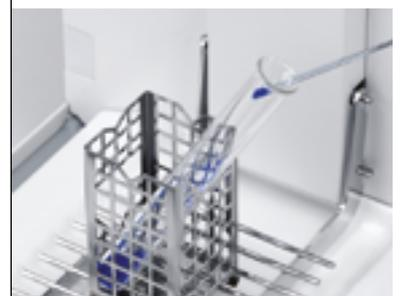
Сетчатая корзинка **ErgoClip** работает подобно клетке Фарадея, защищая весовую ячейку от статических зарядов. Взвешивание становится точнее и безопаснее.
