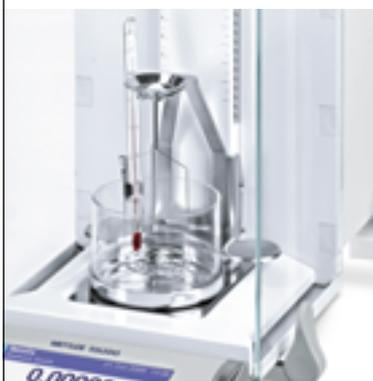
Гидростатическое взвешивание для определения плотности. Определение плотности твердых тел гидростатическим взвешиванием занимает несколько секунд. Расчет проводится лабораторными весами автоматически и результат выводится на дисплей.
