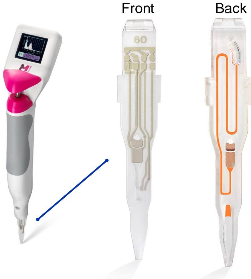
Компактный сенсорный электрод в прецизионно-формованном пробоотборном канале подобен компактному культеровскому счетчику, который был эталонным стандартом для клинического подсчета клеток в течение 50 лет.
