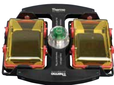
Бакет-ротор M-20 1 , 90°, R макс. 127 мм
