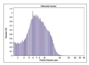
В мультиапертурном режиме программное обеспечение позволяет объединить в одно распределение данные, полученные в ходе серии анализов с использованием апертур с последовательно уменьшающимся диаметром.
