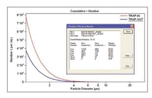
В памяти управляющей станции Multisizer 4e хранится полнаяинформация об импульсах, зарегистрированных в ходе эксперимента. Это позволяет уже после эксперимента повторно проанализировать данные, изменяя диапазон размеров частиц для получения более подробной информации о распределении частиц по размеру. Прибор не просто увеличивает фрагмент распределения, а обрабатывает и повторно анализирует зарегистрированные импульсы, ДЛЯ выбранного диапазона.
