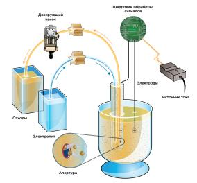
В результате происходит небольшое изменение величины силы тока в усилителе, который преобразует колебания силы тока в импульсы напряжения. Величина скачка напряжения пропорциональна размеру частицы и достаточна для того, чтобы его можно было точно измерить.
