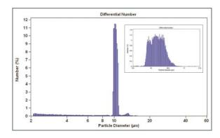
Регистрация изменения размеров частиц в реальном времени стала возможной благодаря запатентованной технологии обработки цифровых импульсов. Это позволяет анализировать скорость клеточного ответа, растворение, агрегацию или диссоциацию частиц.
